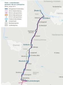
Rund 40 Jahre alt ist die jetzige 220-kV-Stromleitung Stade-Landesbergen. Sie hat für ganz Niedersachsen eine zentrale Versorgungsfunktion. Sie muss durch eine 380-kV-Leitung ersetzt werden, die ebenfalls zu weiten Teilen durch den Landkreis Rotenburg läuft. Am 05.11. gab es hierzu in Verden einen Erörterungstermin, auch mit dem BUND.
